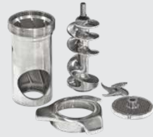
Kovan helezon, somun grubu paslanmaz çeliktir. Gear housing, spiral, nut group are stainless steel.
